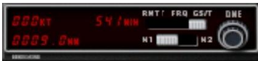
Boîtier de commande d'un récepteur DME avec affichage numérique intégré
