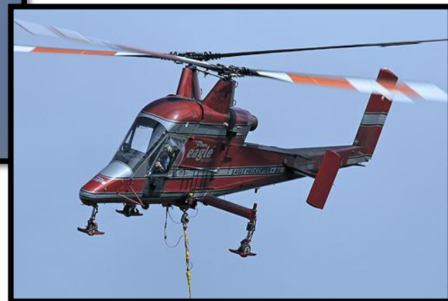
Ou sur 2 axes rapprochés, comme ici sur le KAMAN KMAX1200. On parle de rotors engrenant.
