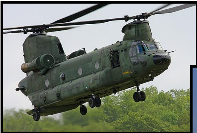
Les 2 rotors peuvent être montés en tandem, comme sur le CH47 Chinook
