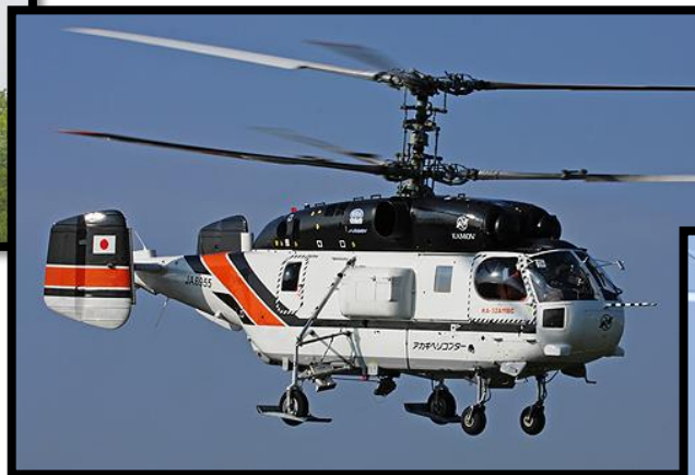
Ou en coaxial (sur le même axe), comme ici sur le KAMOV KA32
