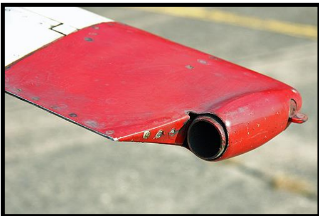
Ou par éjection des gaz en bout de pale comme sur le Djinn
