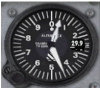
L'indicateur d'altitude du Cessna C172
