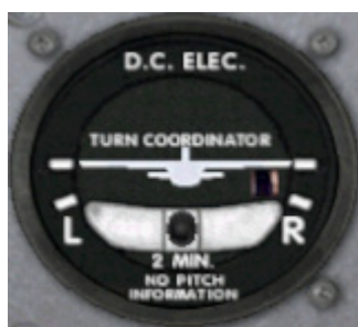
L'indicateur de virage et la bille du Cessna C172
